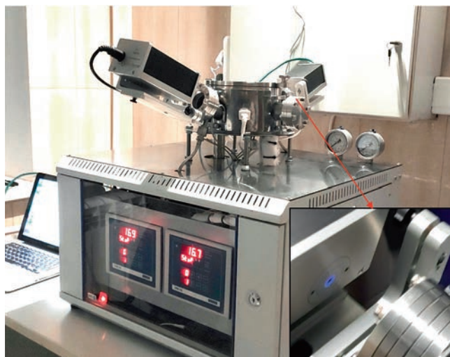
Рис. 6. Прототип технологической платформы атомно-слоевого осаждения с установленным эллипсометром FS-1. Вставка иллюстрирует точное центрирование луча во входном отверстии детектора
