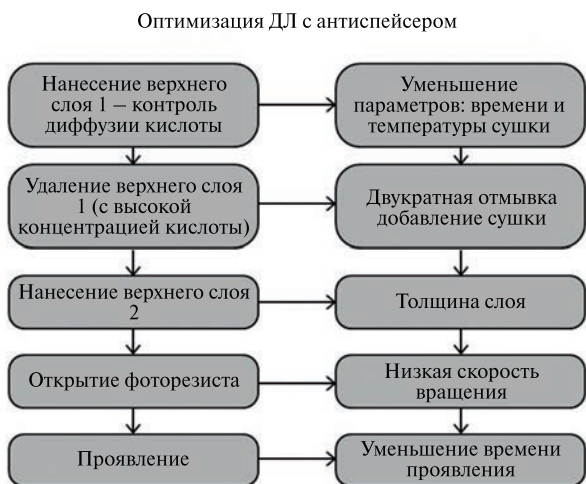
Рис. 4. Ключевые параметры для улучшения и оптимизации этапов процесса ДЛ с антиспейсером
