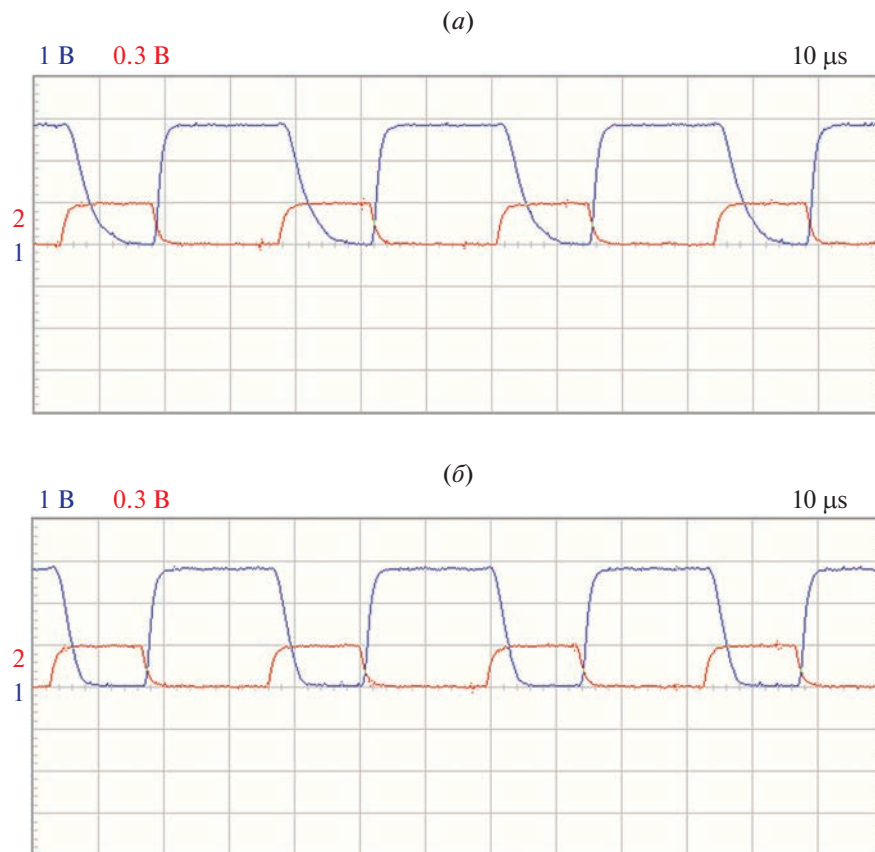
Рис. 4. Осциллограммы ВЧ-сигналов в схеме: красный — входной сигнал; синий — выходной сигнал.
